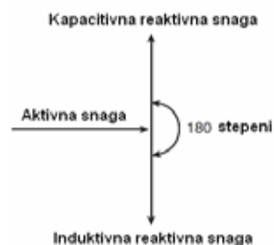
Slika 46: Induktivni i kapacitivni karakter reaktivne snage
