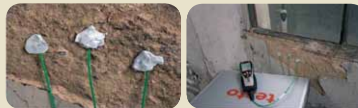
Slika 9: Postupak mjerenja U-vrijednosti spoljašnjeg omotača in-situ
