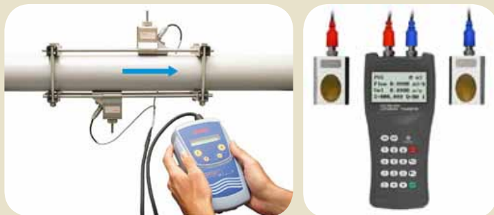
Slika 11: Ultrazvučni mjerач protoka i način mjerenja
